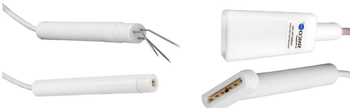
Pinner App 静电发射器包括 5 Point(圆形内藏式 5 根离子针)、Linera Pinner(方形内藏式 4&6 根离子针)和 Pinner Claw(圆形外插可旋装 3 根离子针)，三款发射器均内置限流电阻能有效控制电弧产生，能极好的保护设备免受损坏及避免系统警报并影响产线正常生产。非常适合流延薄膜挤出中的边缘装料，使用的材料允许在高温下使用，电极用防止电弧的电阻器保护。
