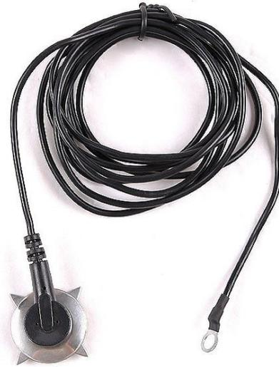
防静电接地线采用 PVC 原料制成，内有 1 兆欧电阻或 0 欧姆电阻，具有多种尺寸可选，静电腕带扣采用塑料带扣外壳，纽扣组合随意拆分，方便实用。采用铜丝线，0.75 平方线，释放静电效果好。星爪扣，采用不锈钢圆片+四星爪和 10mm 公扣组合，安装于工作台释放静电。适用于各种电子行业防静电设备，台面安全接地。
