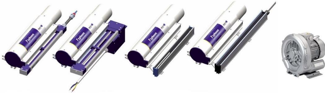
台风风刀利用强大的电离气流中和静电，清除平面和曲面上的污垢，该气流由强大的鼓风机（选件）和气刀产生，风刀标配 EP-Sh-N 离子棒（带电源）或 Performax IQ Easy 离子棒（24V，带管理器可选）。在爆炸危险区域使用时，使用 P-Sh-N-Ex 离子棒（230V）或 Performax Easy Ex 离子棒（24V）或 Performax IQ Easy Ex（24V，带管理器的选项）。
